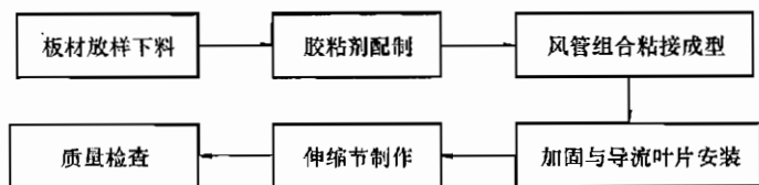
图 5.4.1 玻镁复合风管与配件制作
