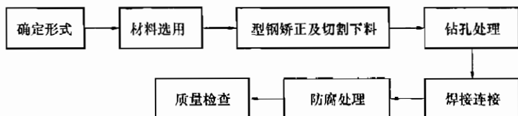
图 7.2.2 支、吊架制作工序
